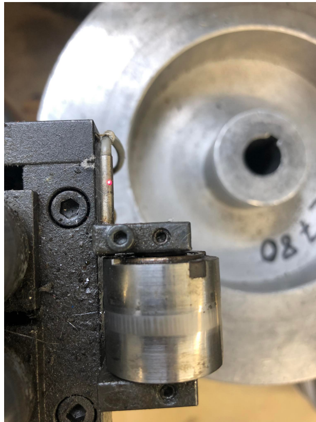
FIGURE 3.9 – Photo vu du haut du rouleau avec son échancrure et du capteur allumé
